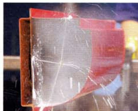
...bei der ersten Salzdusche auf diese Art in jeden Testschweller eingespritzt
